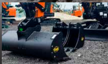
GODETS DE NIVELAGE / CURAGE
