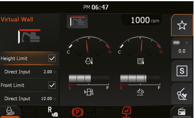
Le système de mur virtuel permet un fonctionnement sécurisé dans les bâtiments
