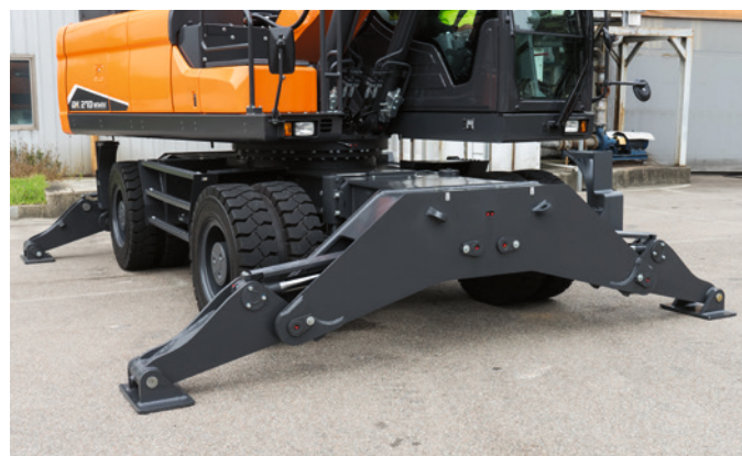
Speziell entwickelter Unterwagen mit breiten Abstützungen für mehr Stabilität
