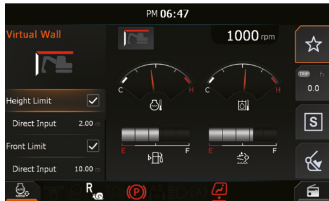
Das System der virtuellen Wand ermöglicht einen sicheren Betrieb in Gebäuden.
