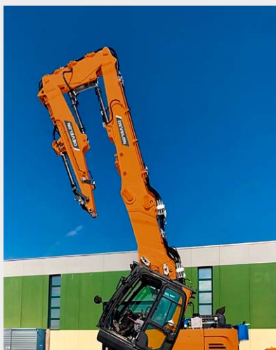
Auswechselbarer Ausleger, Löffelstiel für Abbruch, 2 Meter Verlängerung
