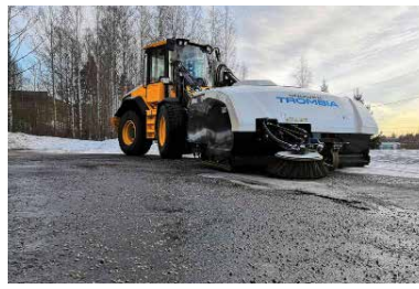
Balayage par températures en dessous de zéro. Trombia n'utilise pas d'eau risquant de geler au sol
