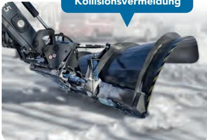
Der Flügel der Snowek Diagonalpflüge ist an einem federbelasteten Schlitten befestigt, der sich aufwärts und zurück bewegt, wenn er auf ein Hindernis trifft. Hierdurch wird die Sicherheit bei der Schneeräumung wesentlich verbessert.
