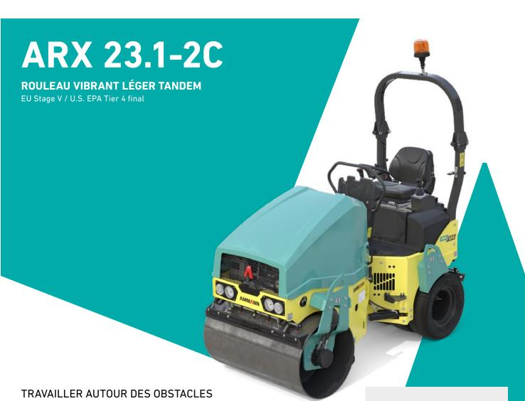
Le tandem léger Ammann ARX 23.1-2C convient parfaitement au marché de la location et aux entrepreneurs qui recherchent une machine performante, équipée d'un tableau de bord intuitifs et ne nécessitant que peu d'entretien.
