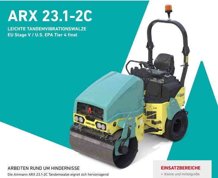
für den Mietmarkt und für Bauunternehmer, die eine wartungsarme Maschine mit einer intuitiv zu bedienenden Bedienplattform einsetzen möchten. Sie ist ebenfalls in der Kombi-Version erhältlich: Bandage vorne und vier Luftreifen hinten. Die Kombi-Version bietet eine Reihe von zusätzlichen Vorteilen. Die Reifen sorgen für einen Kneteffekt, der bei bestimmten Arten von Asphaltmischungen und Temperaturen hochqualitativ verdichtet.
