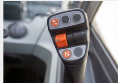
Joystick confortable : il est possible de passer du lièvre à la tortue directement sur le joystick.
