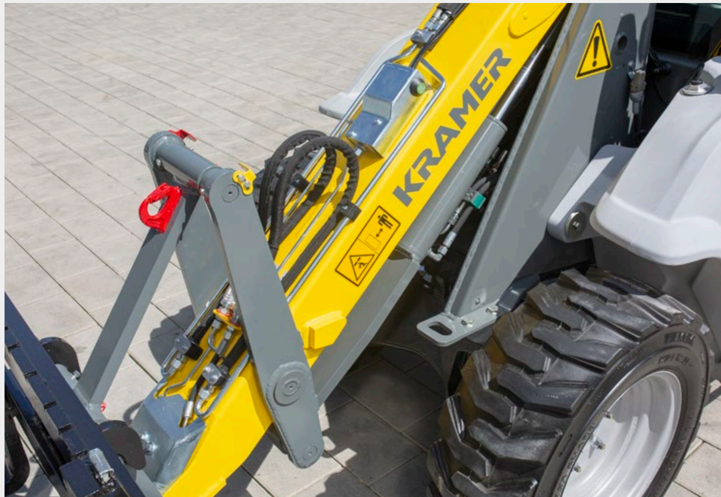
Installation de chargement robuste avec cinématique en Z, affichage visuel de position et crochet de levage en option.
