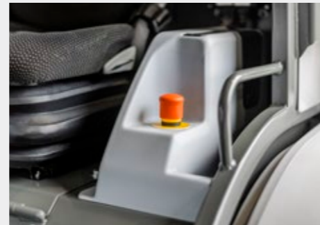
Schnell erreichbarer Notauschalter , damit die Maschine im Gefahrenfall sofort in einen sicheren Zustand versetzt werden kann.
