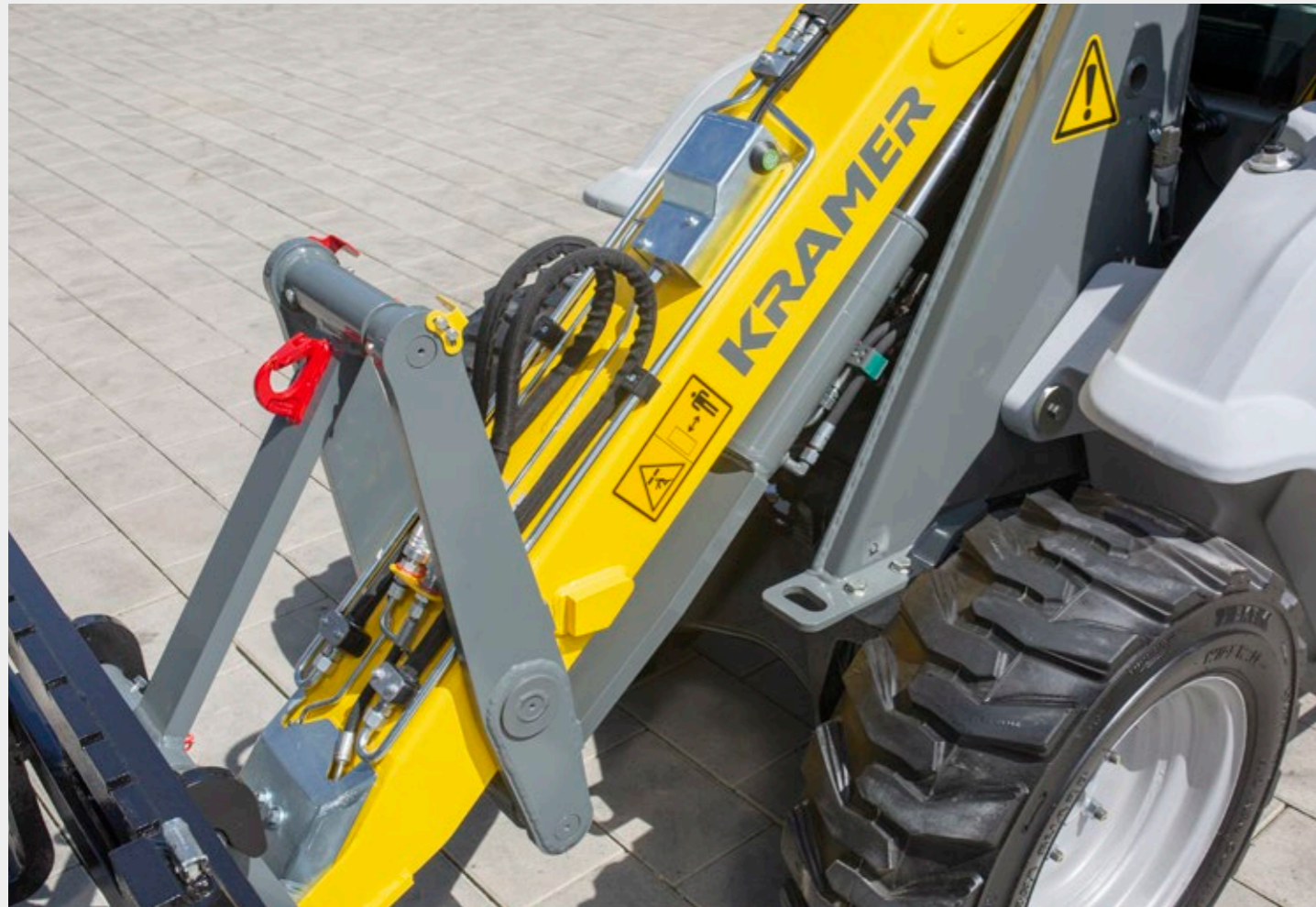
Robuste Ladeanlage mit Z-Kinematik, visueller Positionsanzeige und optionalem Lasthaken.
