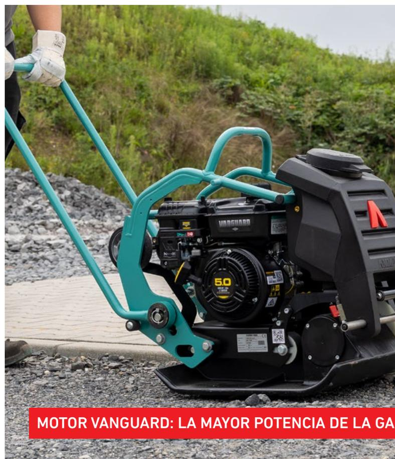
« Gli appaltatori possono scegliere tra un motore diesel o a benzina per il modello APF 20/50. »
