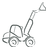
Pale gommate telescopiche Capacità benna: 0,65 - 1,45 m 3
