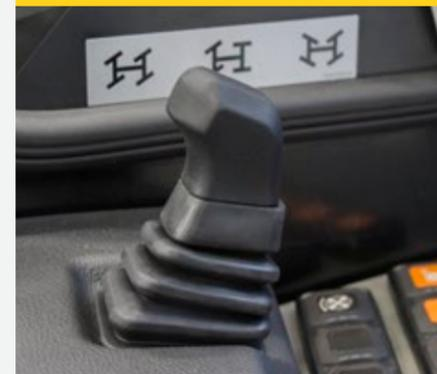
Le passage d'un mode de direction à l'autre est possible à l'aide du levier de commande situé sur le tableau de bord. Qu'il s'agisse de la direction quatre roues motrices, de la direction essieu avant ou de la direction marche en crabe, il existe un mode de direction adapté à chaque application.
