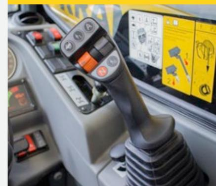
Le joystick multifonctionnel, utilisable intuitivement, est équipé des éléments de commande les plus importants. En mode nuit, les différents boutons et molettes disposent d'un rétroéclairage couleur. De cette manière, l'opérateur peut déterminer immédiatement quelle fonction utiliser et ainsi contrôler sa machine en toute sécurité. Un contrôle sensible et précis de la machine est possible à tout moment.
