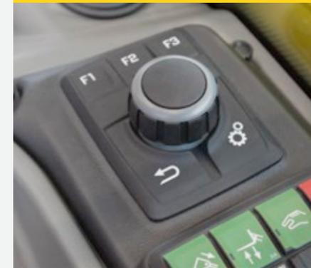
Le Jog Dial en option est principalement utilisé pour le réglage individuel de la quantité d'huile des différents circuits hydrauliques. La sortie se fait via l'instrument d'affichage et est donnée en pourcentage. En outre, d'autres réglages peuvent être effectués dans l'instrument d'affichage.
