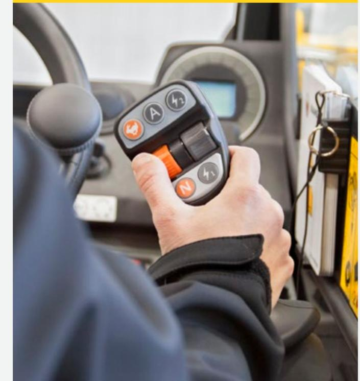
Avec le joystick ergonomique, vous contrôlez toute la machine. Avec jusqu'à 17 fonctions, les tâches les plus importantes peuvent être effectuées sans avoir à lâcher le joystick ou à se déplacer. Le joystick est fixé à la console sur le côté droit de la cabine.
