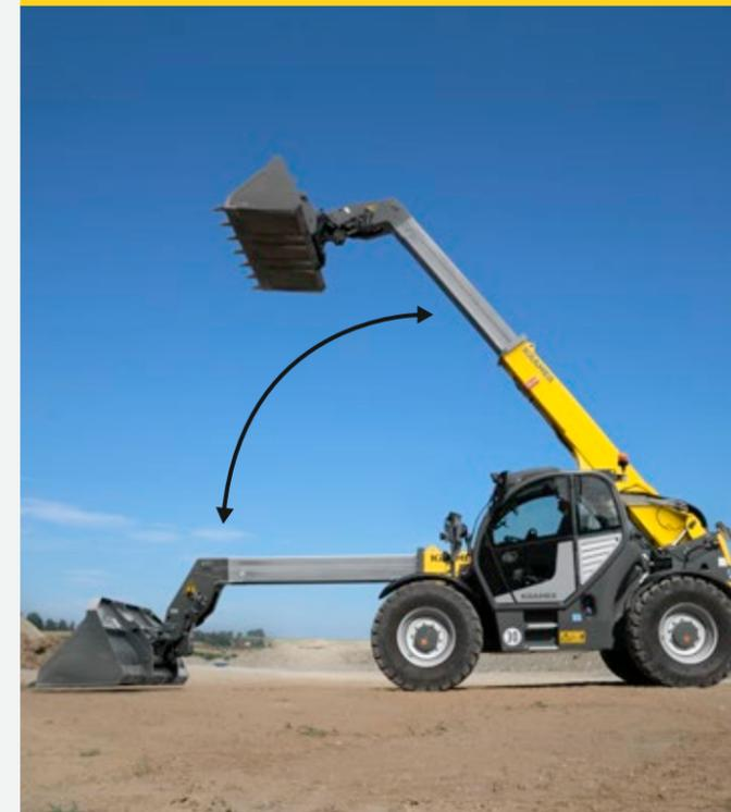
En mode manuel, le bras chargeur n'effectue aucun mouvement automatique. La protection contre la surcharge est bien sûr toujours active et arrête le bras chargeur dès que la limite de surcharge est atteinte. À ce moment, il est uniquement possible de rétracter et soulever le bras chargeur et de basculer l'équipement. En raison de sa catégorie, seule le modèle 2706 dispose de cette sophistication technique supplémentaire.
