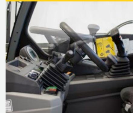
La colonne de direction et le volant peuvent être réglés individuellement en fonction des besoins du conducteur, tant en hauteur qu'en inclinaison. Cela permet également au conducteur d'avoir plus d'espace pour monter et descendre du véhicule. En outre, le volant est fabriqué dans un matériau de haute qualité et offre une bonne prise en main.
