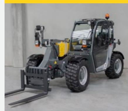
Grâce à sa conception compacte et basse, la longueur totale de la machine reste inférieure à quatre mètres pendant le transport. Ses dimensions compactes, avec une largeur de seulement 1,81 m et une hauteur de 1,95 m, font de cette machine un compagnon irremplaçable pour les travaux dans les espaces confinés.
