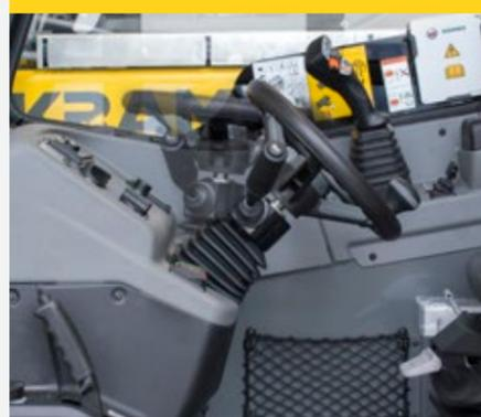
La colonne de direction inclinable et réglable peut être ajustée en fonction des besoins du conducteur. Cela permet au conducteur de travailler avec la machine de manière ergonomique et sans fatigue. En outre, le volant est fabriqué dans un matériau de haute qualité et offre une bonne prise en main.
