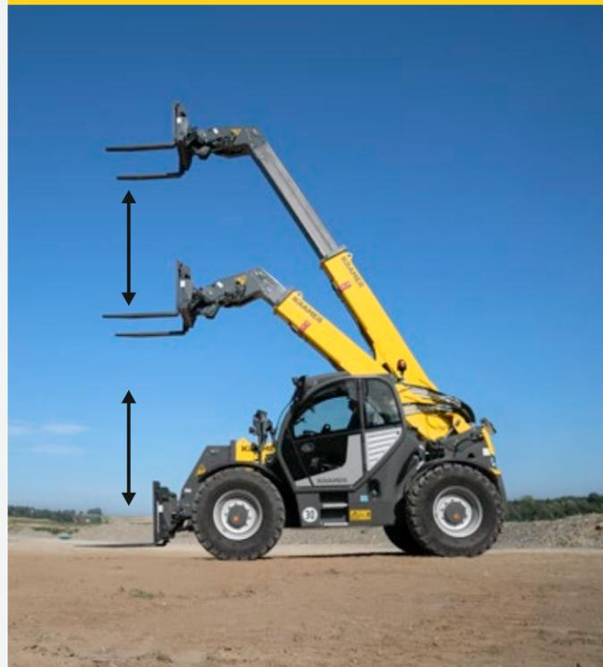
Lors de l'élévation et de l'abaissement du bras chargeur, l'équipement se déplace vers le haut et le bas sur une ligne verticale, c'est-à-dire que le bras télescopique se déploie et se rétracte automatiquement et que le chargement se déplace en ligne droite vers le haut ou le bas. Ainsi, le chargement se trouve toujours à un niveau sûr et les travaux d'empilage à hauteur élevée sont facilités.
