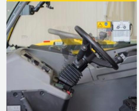
La colonne de direction peut être réglée en inclinaison et en hauteur pour s'adapter aux besoins du conducteur. En appuyant le levier, il est possible de basculer le volant en avant et en arrière. En tirant le levier, le volant est réglé en hauteur. En outre, le volant est recouvert d'un matériau de haute qualité et antidérapant.
