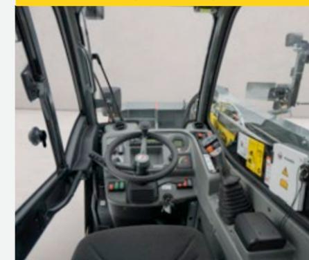
La position centrale des sièges, combinée aux surfaces vitrées généreuses, offre une vue panoramique optimale à 360°. La conception particulièrement claire du 2205 et la position assise du conducteur évitent les « angles morts », même à l'arrière.
