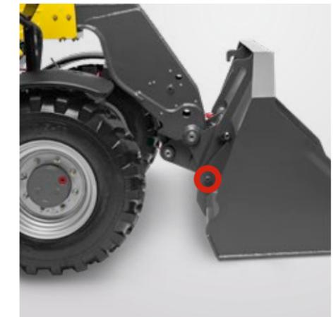
**Changer d'équipement hydraulique (option) : le système d'attache rapide Kramer :** approcher simplement la machine de l'équipement, prendre l'équipement depuis la cabine, puis le verrouiller hydrauliquement en appuyant sur le bouton situé sur le joystick. Le vérin de verrouillage se trouve en dehors du point de rotation de l'attache rapide ; il n'est donc pas situé dans la zone de salissure.
