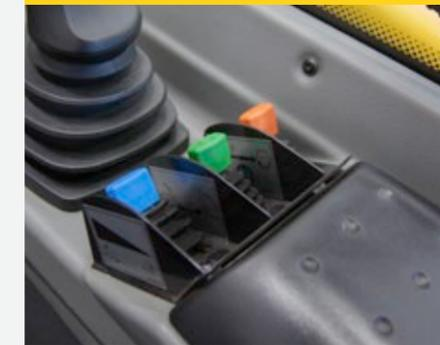
Le dispositif de vitesse lente, y compris l'accélérateur à main, permet de régler le régime moteur optimal de la machine et de l'accessoire, ainsi que la vitesse de travail correcte. Ensuite, les deux valeurs peuvent être adaptées à tout moment à la situation de travail à l'aide d'un jog switch ou d'un curseur. Cela permet des opérations de travail constantes et en même temps sans fatigue.
