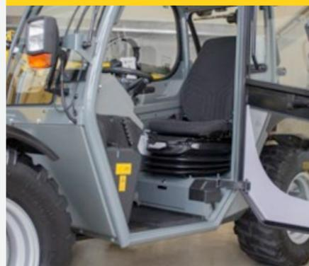
Grâce à la construction basse et à la faible hauteur d'accès correspondante, il est possible d'entrer et de sortir confortablement de la cabine en une seule étape. En outre, deux poignées de maintien montées sur la cabine aident le conducteur à atteindre son poste de travail en toute sécurité.
