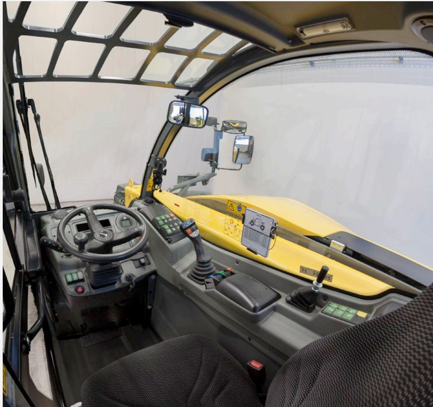
Gute Sicht nach rechts durch groß dimensionierte rechte Scheibe und niedrige Positionierung des Teleskoparms.
