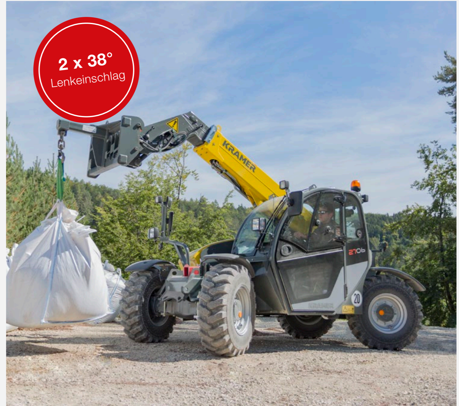
Allradlenkung: besonders wendig bei eingeschränkten Platzverhältnissen
