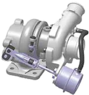
**Turbolader mit Ladedruck-Regelventil:** Leitet Abgase vom Turbinenrad weg, um den Ladedruck optimal zu regeln und den Motor zu schützen. So kann der Turbolader schneller das maximale Drehmoment erzeugen und unterliegt bei hohen Drehzahlen und geringer Belastung einem geringeren Verschleiß. Turbolader erhöhen die Luftdichte, so dass der Motor ungeachtet der Standorthöhe (ü. NN.) mehr Leistung erzeugt.
