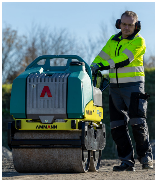
0.5 mm AMPLITUDE POUR UTILISATION SUR LES SOUS-COUCHES OU LES COUCHES DE BASE NON LIÉES
