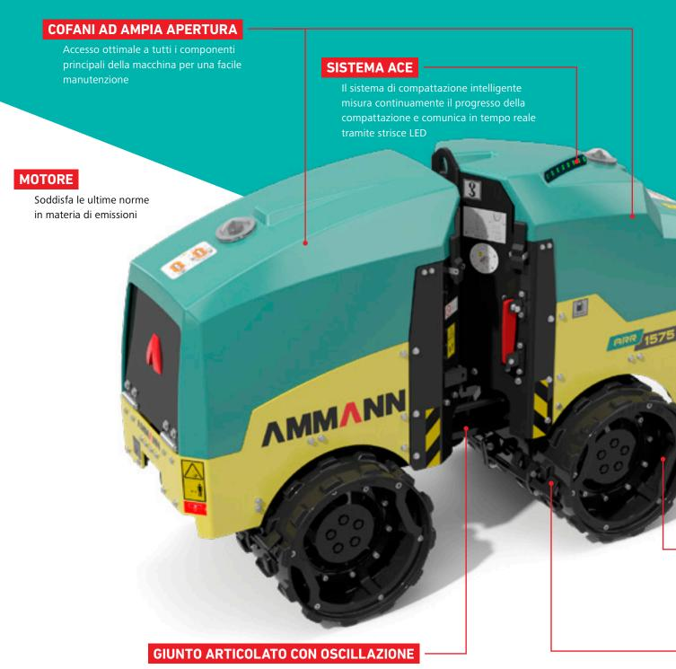
Collega il telaio anteriore e posteriore, assicurando una distribuzione equilibrata del peso e un contatto permanente con il suolo
