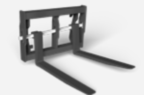
Stapeleinrichtung Gabelzinken schwimmend gelagert
