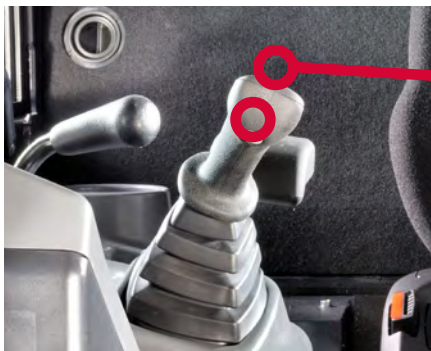
1 Dauerfunktion für Zusatzsteuerkreise
