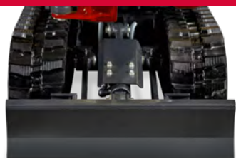
← → Ausgefahrenes Fahrwerk: 830 mm
