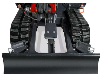
Eingefahrener Unterwagen : 980 mm
