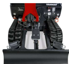
Eingefahrener Unterwagen: 980 mm
