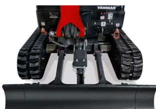
Ausgefahrener Unterwagen: 1170 mm
