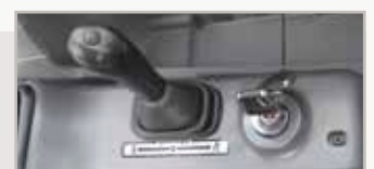
Planierschild-Schwimmstellung und Fahrtmoduswähler
