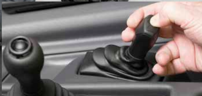
Leva per il ribaltamento del cassone con pulsante di accelerazione
