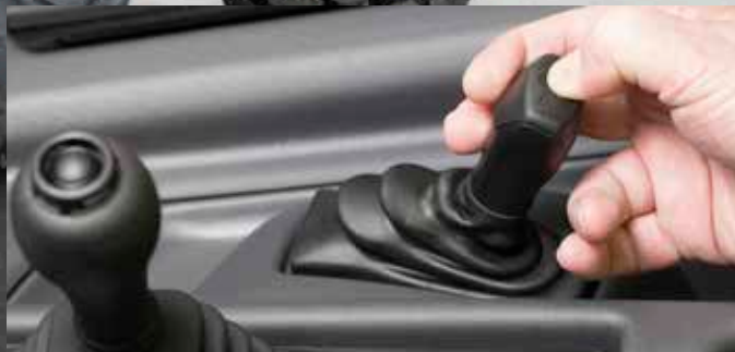
Levier de commande de la benne avec contacteur d'accélération
