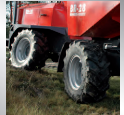
die Pendelachse ermöglicht eine hohe Stabilität
