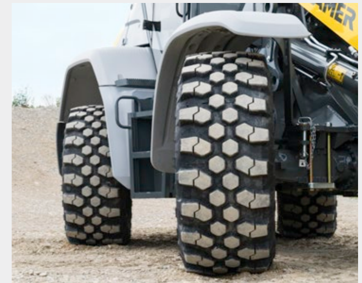
Direction marche en crabe pour une flexibilité maximale
