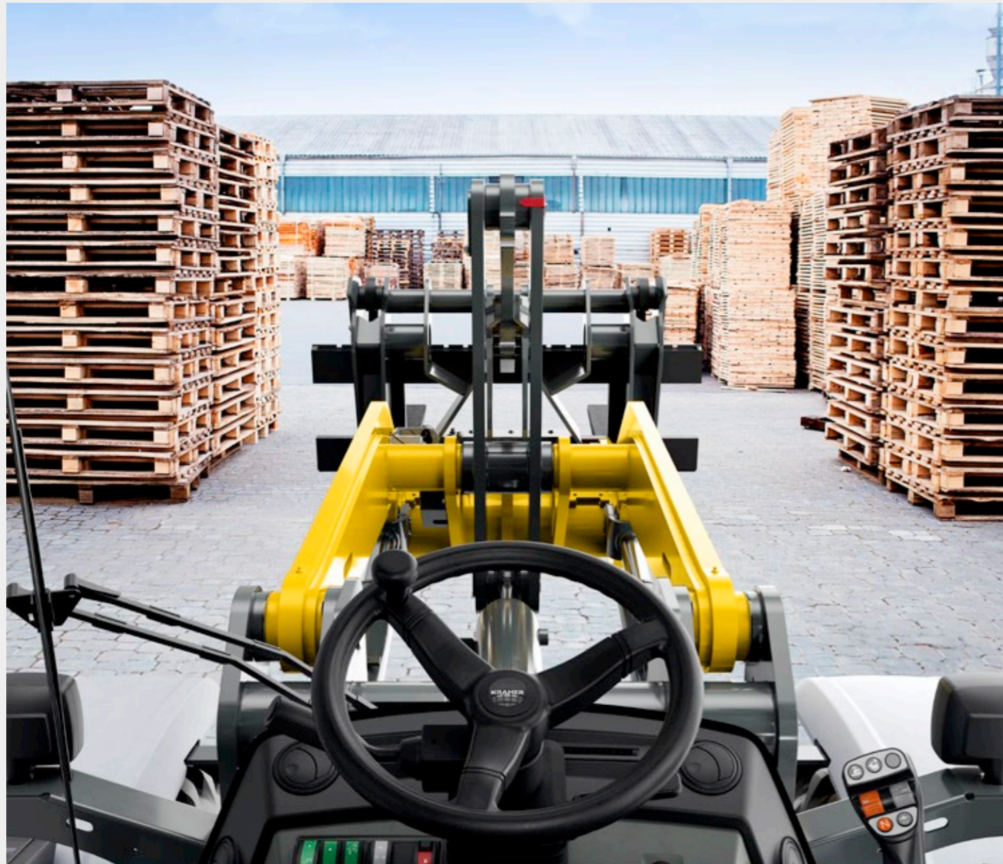
Excellente visibilité panoramique : les arceaux de la cabine fins et les vitres panoramiques offrent une visibilité optimale de tous les côtés.
