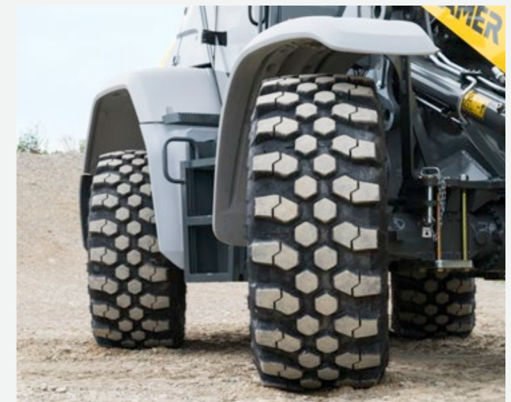
Hundeganglenkung für maximale Flexibilität
