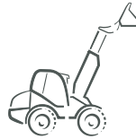
Chargeuse télescopique Capacité du godet : 0,65 - 1,45 m 3
