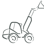
Teleskopradlader Schaufelinhalt: 0,65 - 1,45 m 3
