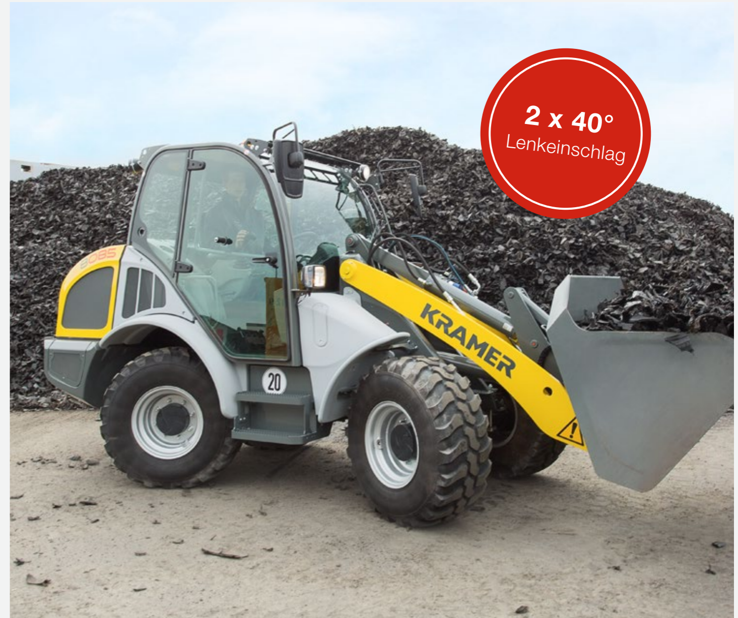
Allradlenkung besonders wendig bei eingeschränktem Platz
