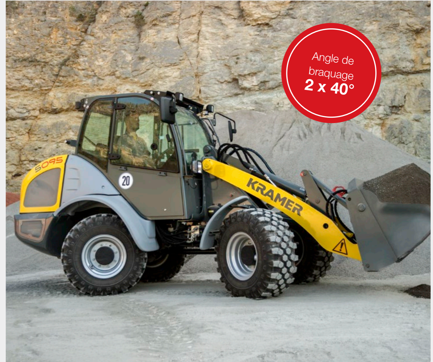
Quatre roues directrices pour une grande maniabilité, en particulier dans des conditions d'espace limité
