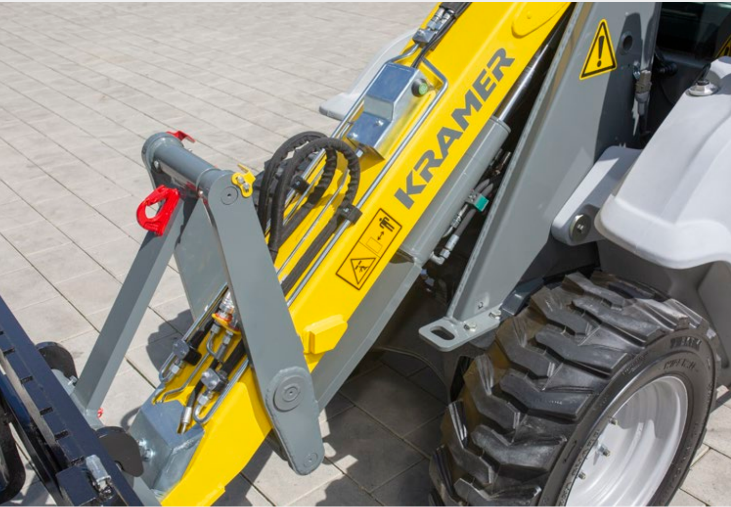
Robusto sistema di carico con cinematica a Z, indicatore visivo di posizione e gancio opzionale.
