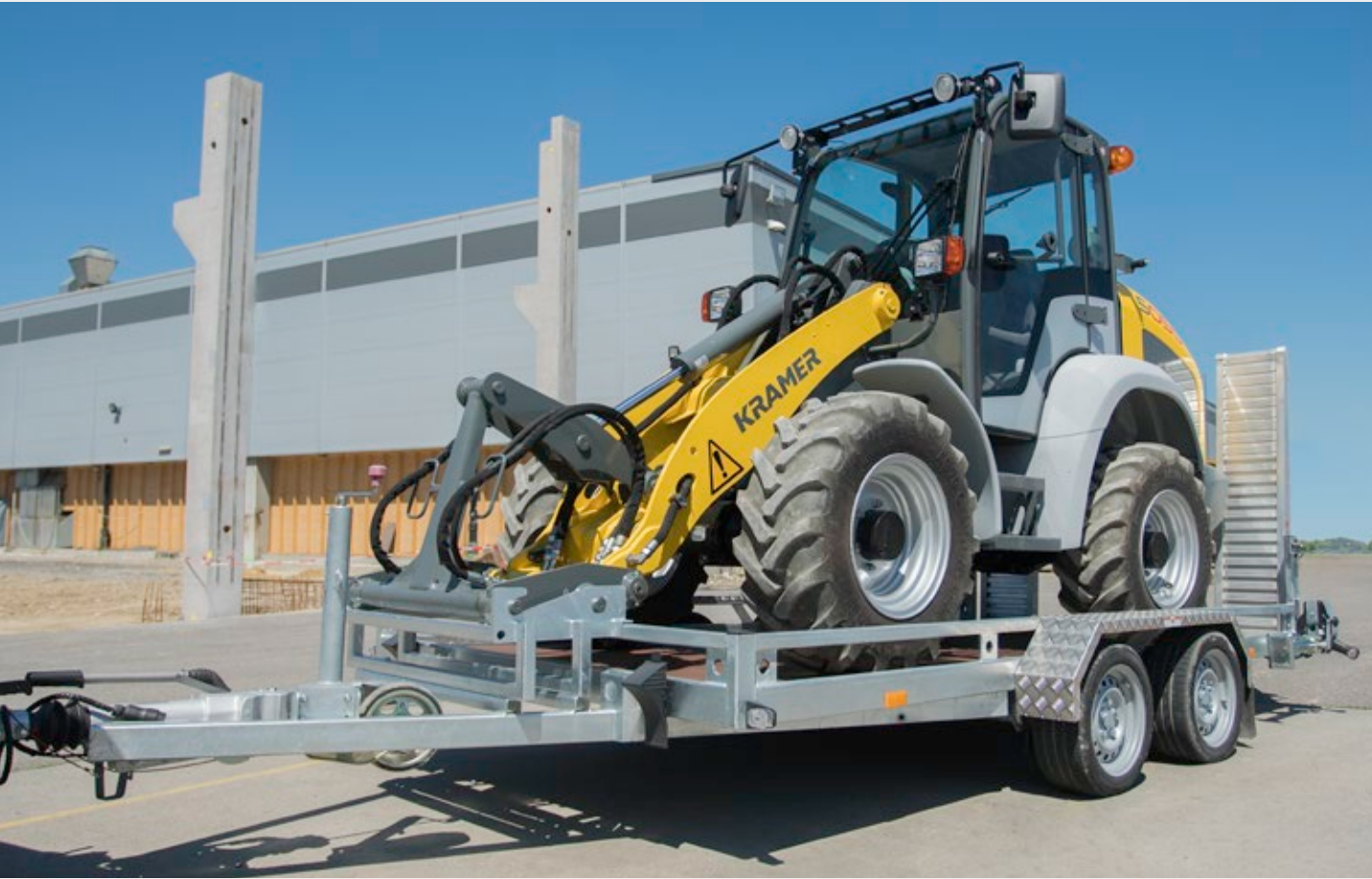
Fissaggio rapido e semplice del carico con il bloccaggio dell'attacco a cambio rapido Kramer direttamente al rimorchio.
