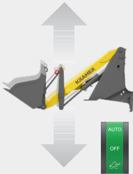
Lo stabilizzatore automatico del carico impedisce l'oscillazione della macchina e riduce la perdita di materiale.
