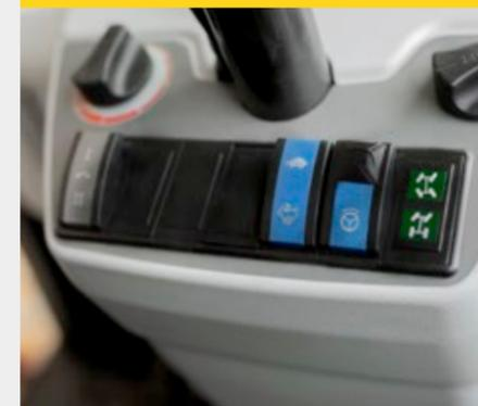
Le marquage couleur des interrupteurs permet d'identifier chaque groupe de fonctions très rapidement. Rouge = sécurité, Vert = hydraulique, Bleu = conduite et Gris = électrique. Le conducteur dispose ainsi de conditions de pilotage confortables et sûrs, sans risque de confondre les boutons. Le résultat ? Une meilleure efficacité de travail du conducteur.
