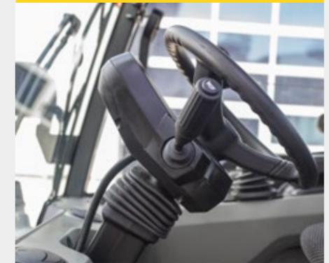
La colonne de direction inclinable en option est adaptable aux besoins du conducteur. Le volant est constitué d'un matériau de haute qualité et facile à saisir. En outre, un indicateur moderne avec retour automatique du clignotant se trouve sur la colonne de direction.
