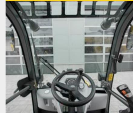
La position centrale du siège conducteur offre une visibilité panoramique à 360°. Le design bien dégagé de la machine permet d'éviter les angles morts. Tout reste à portée de vue, même à l'arrière. Même avec l'installation de chargement télescopique de la 5065T déployée, l'opérateur conserve une vue parfaite sur l'équipement.
