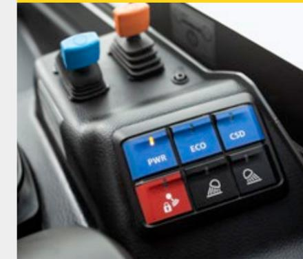
La fonction de la 5040 comprend trois modes de conduite qui peuvent être modifiés par simple pression de bouton pour répondre plus efficacement aux besoins. Le mode Power (PWR) convient pour les travaux de godet, le mode ECO pour les travaux d'empilement ou sur route et le mode Slow Speed Drive (CSD) pour les équipements hydrauliques.
