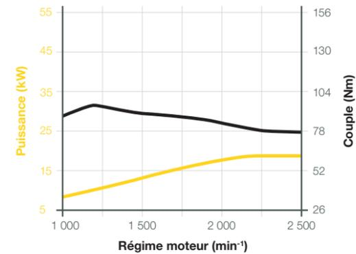
Courbe de puissance Yanmar 3TNV86CT ; 28,5 kW ; Phase V (standard)
