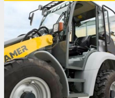
Le large espace de montée/descente permet d'accéder à la cabine de l'opérateur. Le châssis monobloc permet également d'accéder facilement à la machine, et ce même avec un angle de braquage maximal. L'accès se fait via un marchepied. Afin de permettre à l'opérateur de monter et de descendre en toute sécurité, les poignées sont positionnées de manière à garantir une bonne ergonomie.
