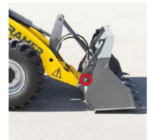
**Changer d'équipement hydraulique : le système d'attache rapide Kramer :** approcher simplement la machine de l'équipement, fixer l'équipement depuis le siège conducteur, puis verrouiller l'équipement hydrauliquement en appuyant sur le bouton situé sur le joystick. Le vérin de verrouillage se trouve en dehors du point de rotation de l'attache rapide ; il n'est donc pas situé dans la zone de salissure.
