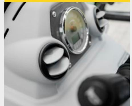
Le chauffage puissant avec ventilation vers les vitres et les sorties d'air chaud au plancher assurent un travail agréable, même par temps froid. Un climatiseur entièrement intégré est disponible en option. La pédale combinant inching et freinage permet de manœuvrer avec précision, et ce même avec un régime moteur élevé.
