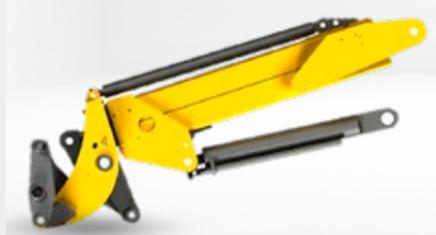
La conception robuste et modulaire de l'installation de chargement télescopique offre une excellente visibilité sur l'équipement. Les avantages de la cinématique en Z : lors du redressement du godet, une plus grande force d'arrachement est obtenue pour la même taille de cylindre, car le côté piston du vérin hydraulique est alimenté en pression lors du redressement.
