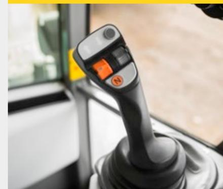
Le joystick montre ses qualités surtout lorsqu'il commence à faire sombre. En mode nuit, les différents boutons et molettes disposent d'un rétroéclairage couleur. De cette manière, l'opérateur peut déterminer immédiatement quelle fonction utiliser et ainsi contrôler sa machine en toute sécurité.
