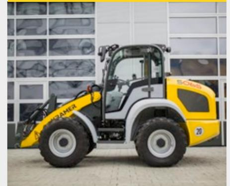
Les machines offrent les meilleures caractéristiques pour travailler dans les passages bas. Toutes les machines ont une hauteur totale inférieure à 2,5 m. La conception compacte de la chargeuse sur pneus 5050 permet de la transporter facilement sur une remorque de 3,5 tonnes.
