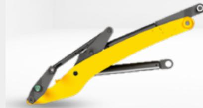
L'installation de chargement orientée en parallèle garantit une force de levage constante et une utilisation en toute sécurité lors du transport de matériaux. Grâce à l'angle de cavage jusqu'à 45°, le godet de la chargeuse sur pneus ne laisse échapper aucun matériau, et ce même lorsque le godet est complètement rempli. L'angle de déversement jusqu'à 45° permet quant à lui de vider complètement le godet.
