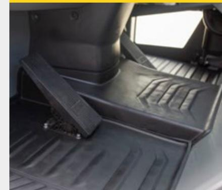
Le tunnel central dans le plancher de la cabine ne présente une hauteur de seulement 5 cm en raison de la conception du châssis de la machine. Le chauffeur peut ainsi monter et descendre facilement du véhicule. Le tunnel central est également couvert d'un tapis en caoutchouc et peut être facilement nettoyé.
