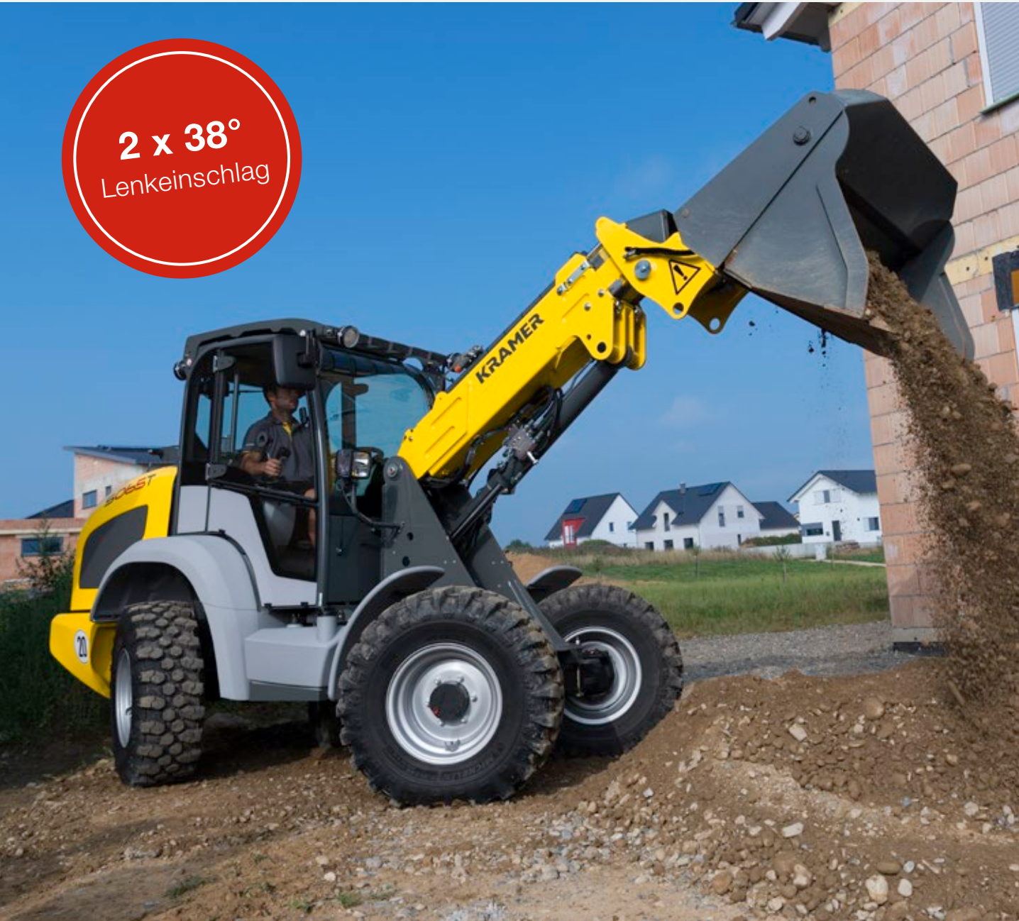
Allradlenkung: besonders wendig bei eingeschränktem Platz
