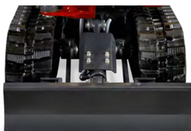
Sottocarro contratto, 680 mm : facilità di manovra
