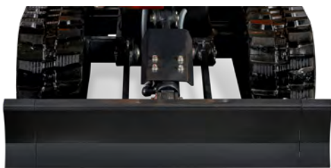
Ausgefahrener Unterwagen 840 mm – Mehr Standfestigkeit
